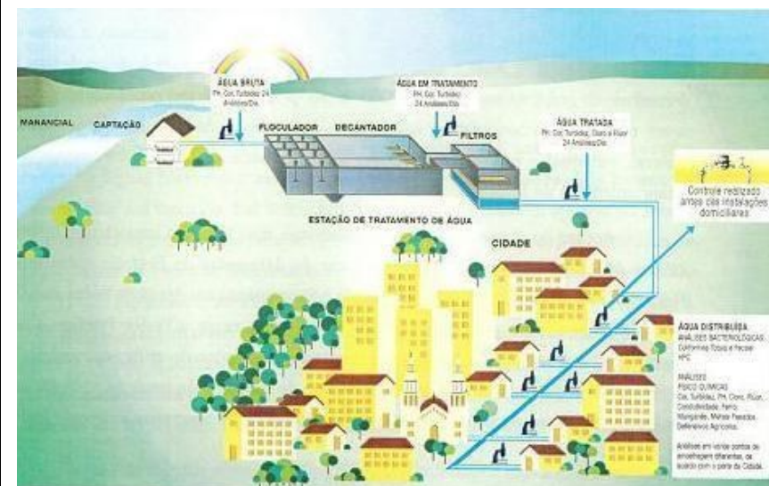
Figura 2 – Esquema do controle de qualidade – Portaria 36
